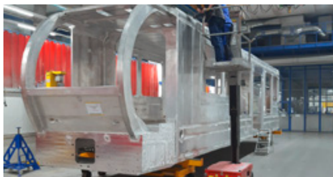
Ein Rohwagenkasten eines neuen BLM-Zuges bei der Abnahme am 28. November 2022 bei Stadler Rail in Bussnang. Der Kasten ist aus 100 % Aluminium gefertigt, wird nun sandgestrahlt und dann lackiert.
