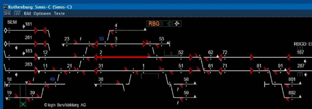
1LTIS-Lupe Stellwerk Rothenburg mit aktiver Zuglenkung (Quelle: login.org)
