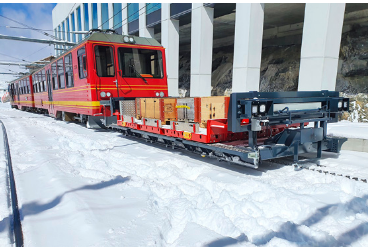
Niederflur-Vorstellgüterwagen in Betrieb am Eigergletscher
