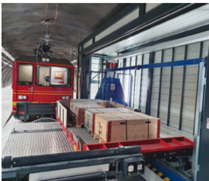
Verladeautomat und Niederflur-Vorstellgüterwagen Jungfrauoch
