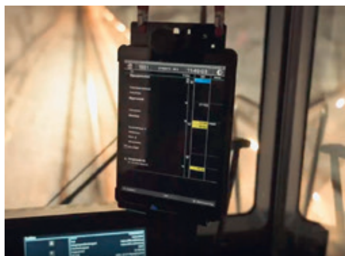
Dank Beacons funktioniert das ÖV-Pad auch im langen Tunnel der Jungfraubahn
