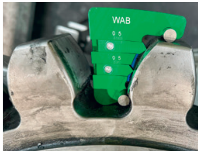
Verschleissmessung am Zahnrad (Quelle: Wengernalpbahn)
