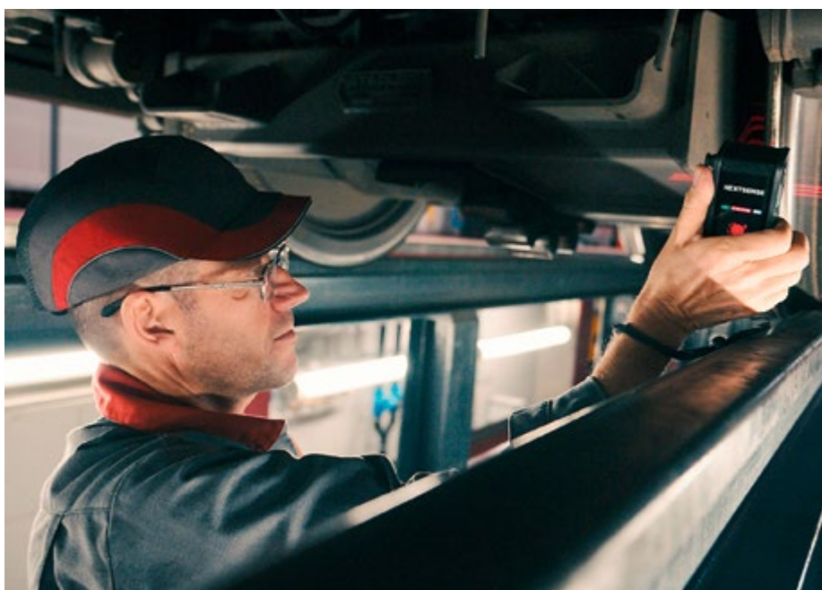
Radsatzinspektion mit Laservermessungsgerät
