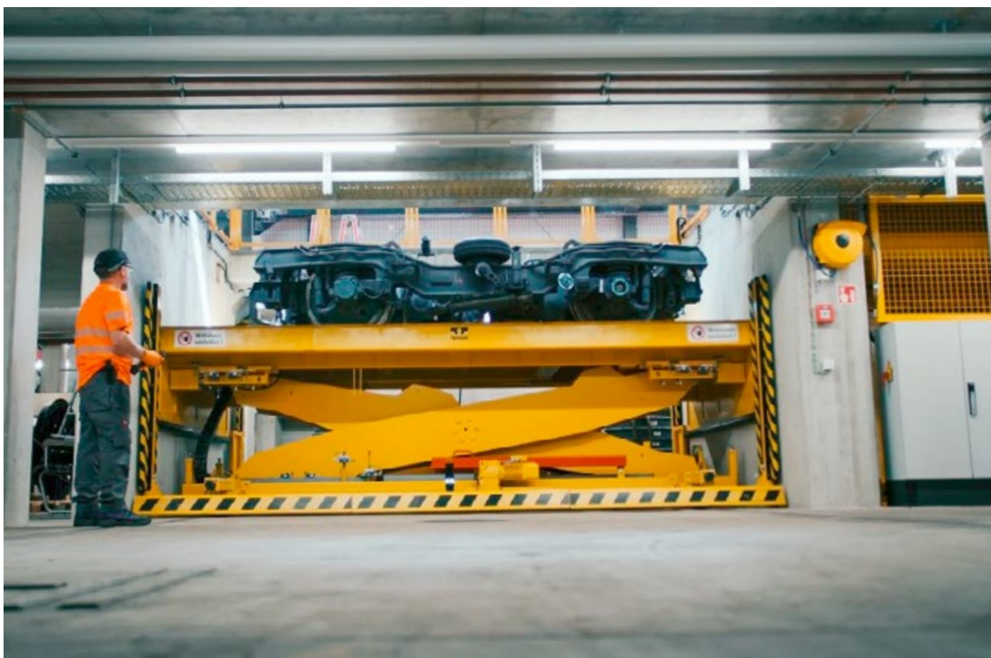
Drehgestell wird zur Überführung in die Komponentenaufarbeitung abgesenkt
