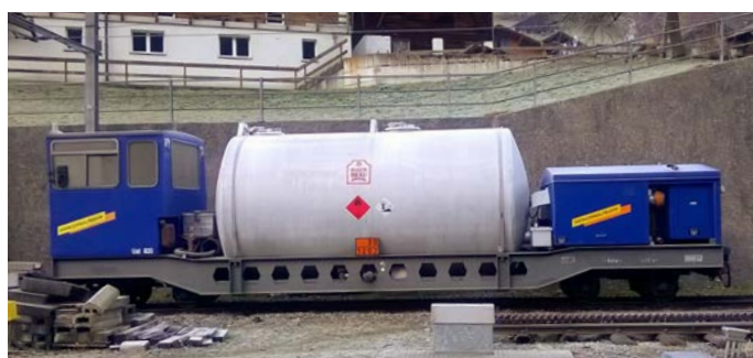
Heizölkesselwagen für den Transport von Heizöl
